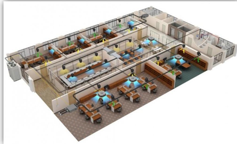
*Immagine a puro titolo esemplificativo di un sistema VRF completo di sistema di rinnovo e purificazione dell'aria dotato di recupero di calore*
