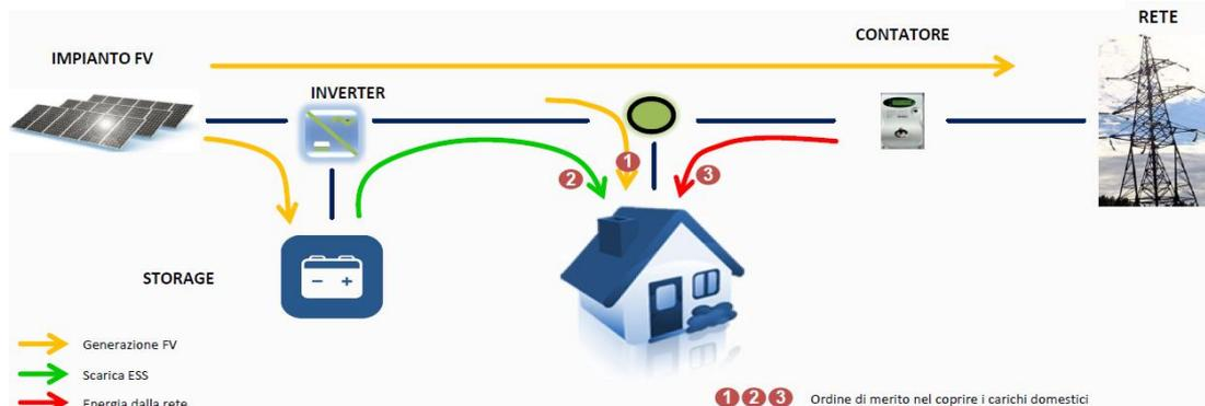
*In condizioni di particolare consumo dell'utenza, si possono creare le condizioni per l'erogazione di energia simultanea da fotovoltaico + batteria (+ rete).*
