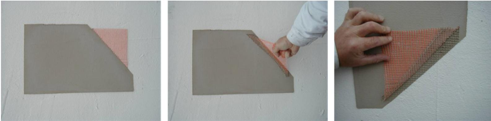
La rete viene strappata dalla malta di armatura ➔ supporto portante
