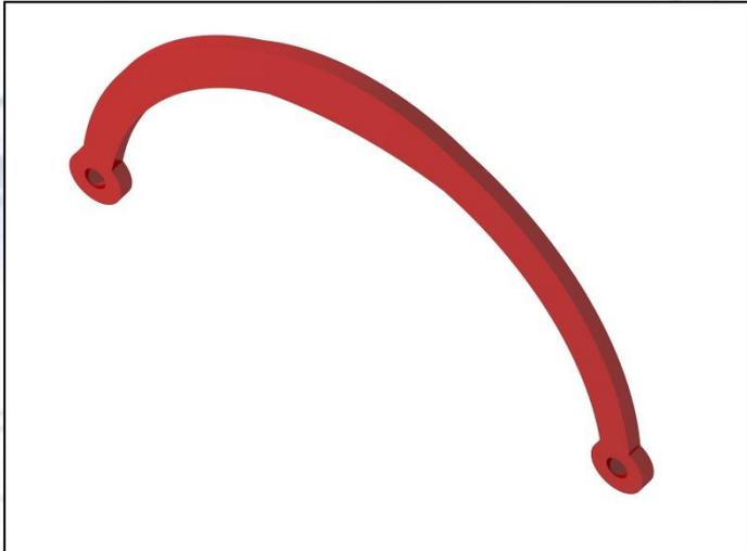
*Il tratto centrale del dissipatore è stato progettato con una sezione più ampia e sovradimensionata per avere maggiore resistenza alla deformazione.*
