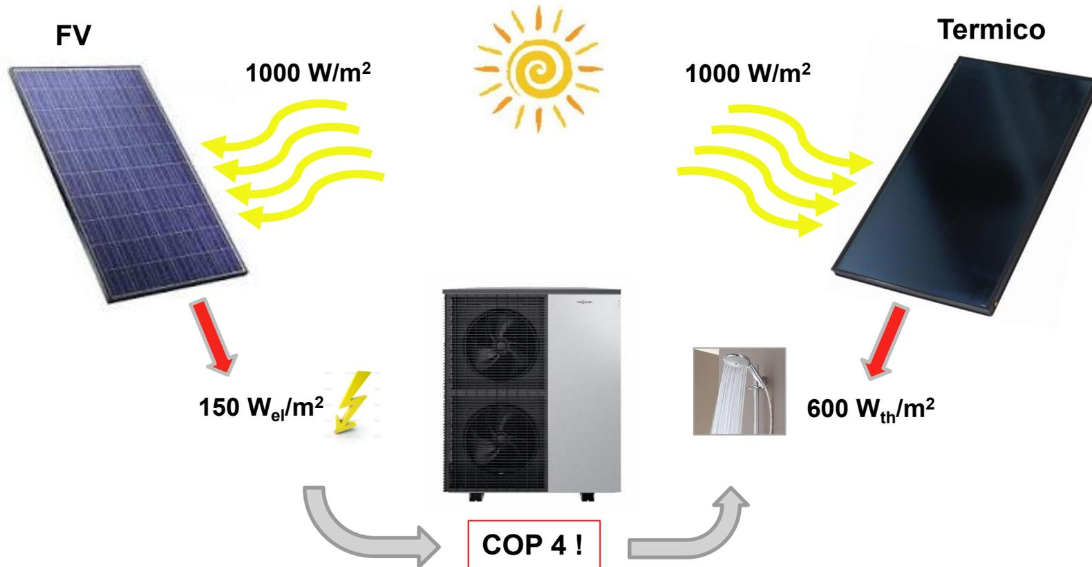
Il solare termico per la produzione ACS, è ad oggi la soluzione «green» più performante
