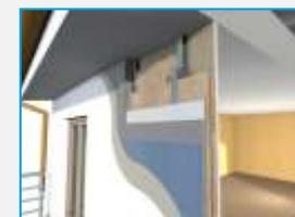
\*Sistema di isolamento termico a cappotto (ETICS, Exterior Thermal Insulation Composite System)
