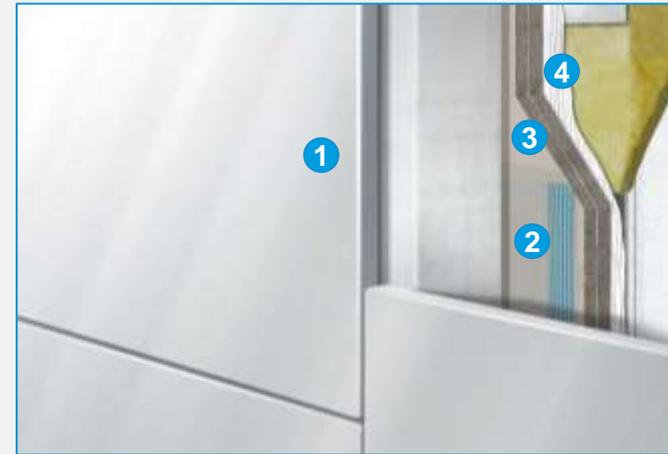
1. Rivestimento in alluminio con sottostruttura
