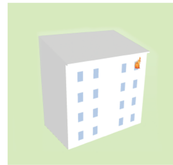
Fig. 4: Incendio in un appartamento che raggiunge la facciata combustibile dalla finestra e può estendersi alla copertura
