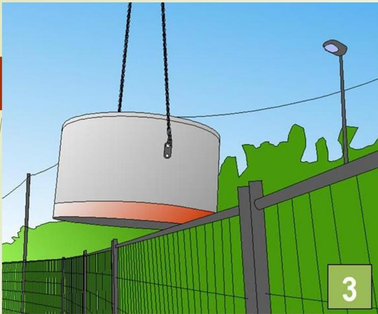
Posizionato il primo elemento si procederà alla posa di quelli successivi con le medesime modalità, verificando costantemente la verticalità delle pareti degli anelli; raggiunta la quota di progetto si potrà dare corso
